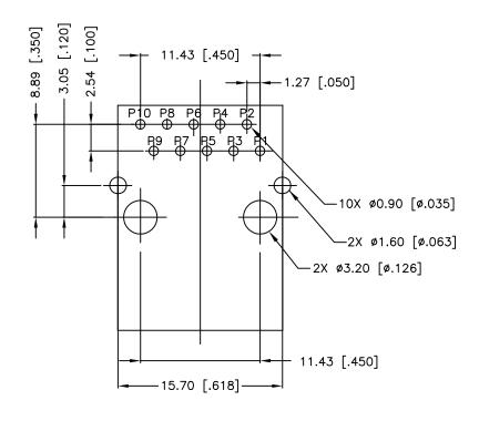
RECOMMENDED PWB LAYOUT (COMPONENT SIDE SHOWN)
