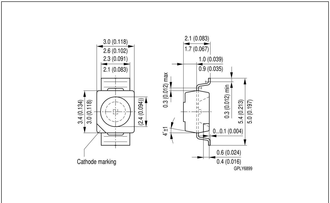
Maße werden wie folgt angegeben: mm (inch) / Dimensions are specified as follows: mm (inch).
