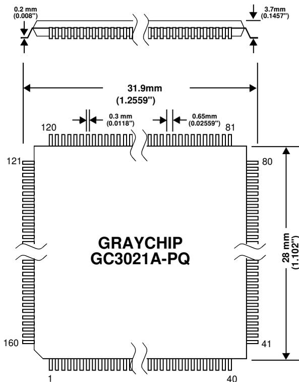
160 PIN PLASTIC QUAD FLAT PACK CHIP CARRIER
