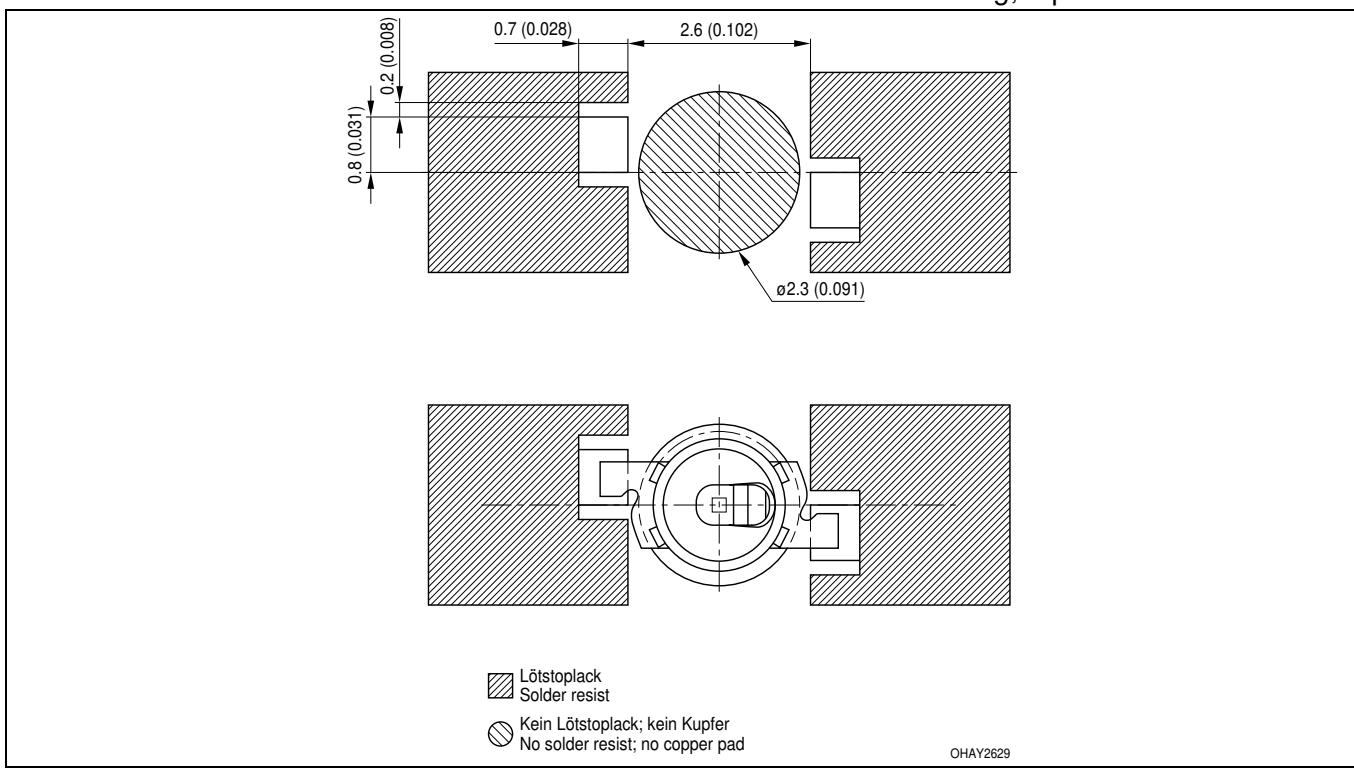
**Gurtung / Polarität und Lage<sup>8)</sup> Seite 18****Montage von oben****Method of Taping / Polarity and Orientation<sup>8)</sup> page 18
