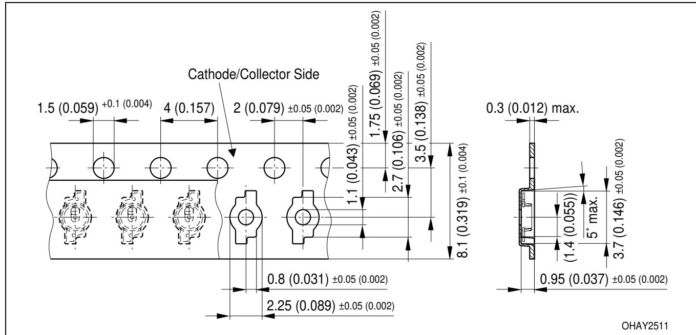
**Gurtung / Polarität und Lage<sup>8)</sup> Seite 18****Montage von unten****Method of Taping / Polarity and Orientation<sup>8)</sup> page 18
