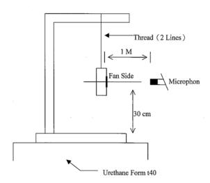
1 METER FROM MICROPHONE TO FAN INTAKE
