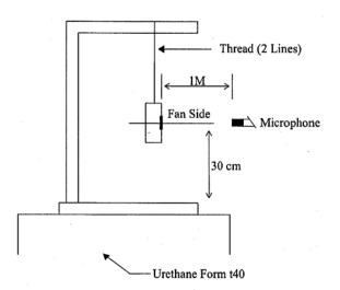
1 METER FROM MICROPHONE TO FAN INTAKE
