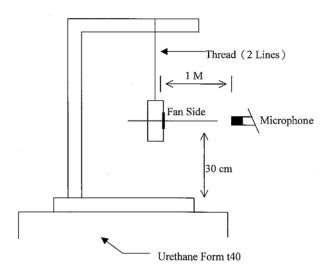
1 METER FROM MICROPHONE TO FAN INTAKE
