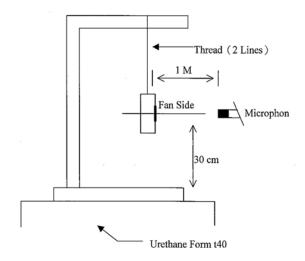
1 METER FROM MICROPHONE TO FAN INTAKE
