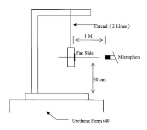
1 METER FROM MICROPHONE TO FAN INTAKE
