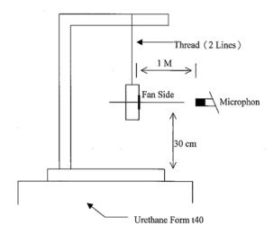
1 METER FROM MICROPHONE TO FAN INTAKE
