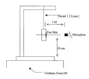
1 METER FROM MICROPHONE TO FAN INTAKE
