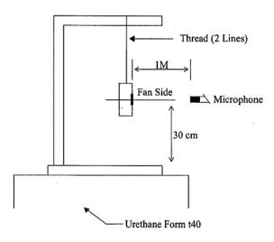
1 METER FROM MICROPHONE TO FAN INTAKE
