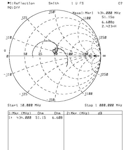
Figure 12. LNA Input Impedance
