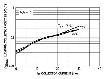
Figure 27.  $V_{CE(sat)}$  versus  $I_C$
