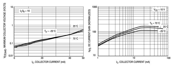
Figure 17.  $V_{\text{CE(sat)}}$  versus  $I_{\text{C}}$
