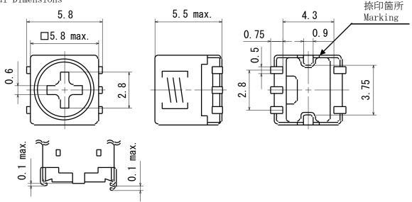
一般寸法公差 ±0.2 単位 mm Tolerance Unit
