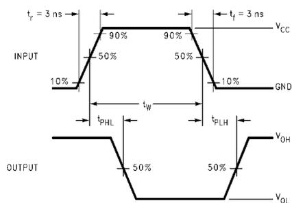
**FIGURE 12. AC Waveforms**
