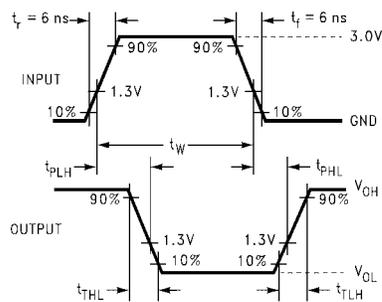
**FIGURE 3. AC Waveforms**
