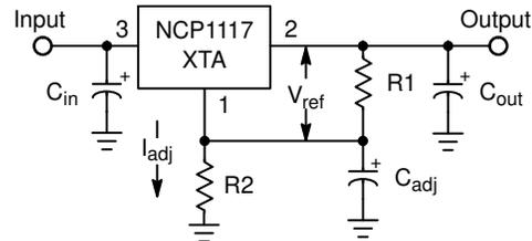
$$V_{out} = V_{ref} \left( 1 + \frac{R2}{R1} \right) + I_{adj} R2$$
