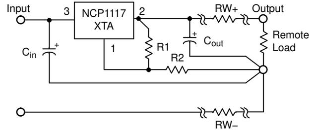
**Figure 26. Load Sensing**
