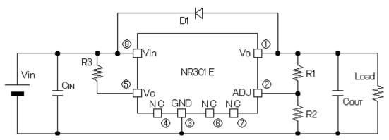
Cin : 1  $\mu$  F/50V, Cout : 1  $\mu$  F/50V, R1 : 39k  $\Omega$  +1k  $\Omega$  , R2 : 10k  $\Omega$
