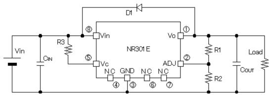
Cin :  $1 \mu$  F/50V, Cout :  $1 \mu$  F/50V, R1 :  $39k \Omega + 1k \Omega$ , R2 :  $10k \Omega$
