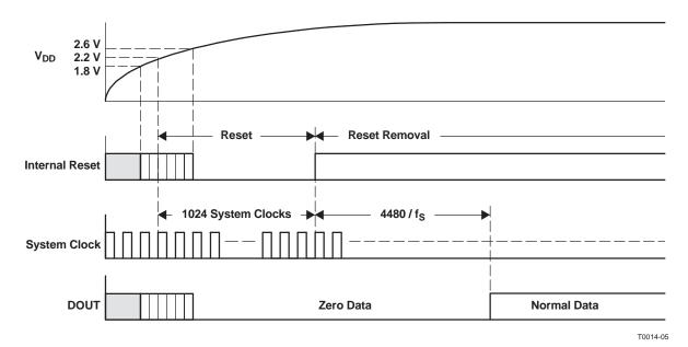
Figure 17. Internal Power-On-Reset Timing
