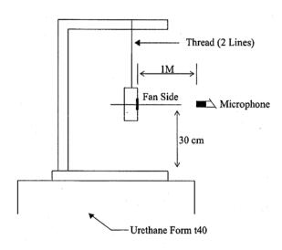
1 METER FROM MICROPHONE TO FAN INTAKE
