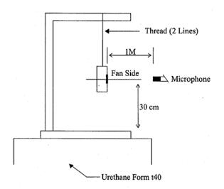
1 METER FROM MICROPHONE TO FAN INTAKE
