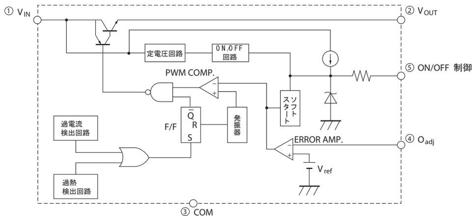
图15 降压出力回路構成
