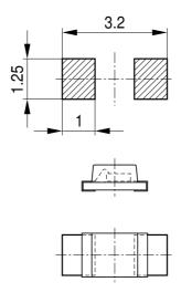
Bauteil positioniert Component location on pad OHFP2578
