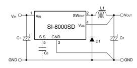
$C_1 : 50V/1000\mu F$   $C_2 : 50V/1000\mu F$   $C_3 : 0.01\mu F$
