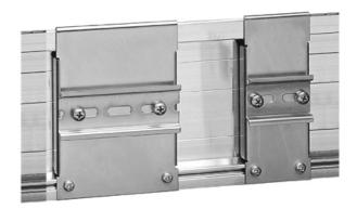
PULS Schaltnetzteile oder auch andere Hutschienen-Geräte lassen sich auf die andersartige S7-300-Schiene mit Hilfe der SLZ10- bis SLZ14-Adapter montieren. Damit entfällt die Montage einer zusätzlichen Hutschiene. Der Adapter besteht aus einer Halterung, die auf die S7-300 Schiene eingehängt und auf der Unterseite mit zwei mitgelieferten Schrauben befestigt wird. Auf dieser Halterung ist ein entsprechend langes Hutschienen-Stück fixiert, auf das dann das Hutschienen-
