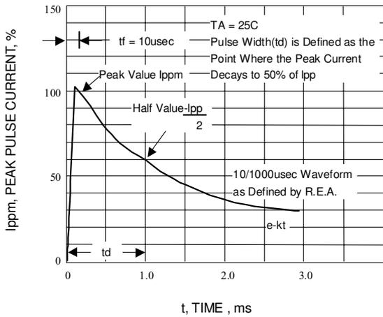
Fig. 3-PULSE WAVEFORM
