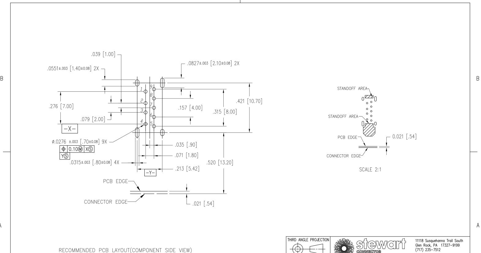
RECOMMENDED PCB LAYOUT(COMPONENT SIDE VIEW)
