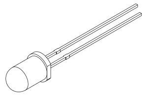
ELECTRO-OPTICAL CHARACTERISTICS Ta=25°C If=20mA PARAMETER TYP UNITS TEST COND PEAK WAVELENGTH 630 FORWARD VOLTAGE 2.1 2.6 ۷f If=20mA REVERSE VOLTAGE 5.0 ۷r Ir=100µA LUMINOUS INTENSITY 15000 If=20mA mcd VIEWING ANGLE 15 2x theta EMITTED COLOR: RED EPOXY LENS FINISH: WATER CLEAR
