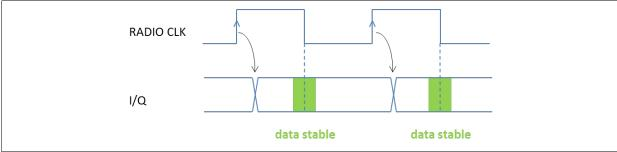
Figure 4: I/Q on Clock Rising Edge
