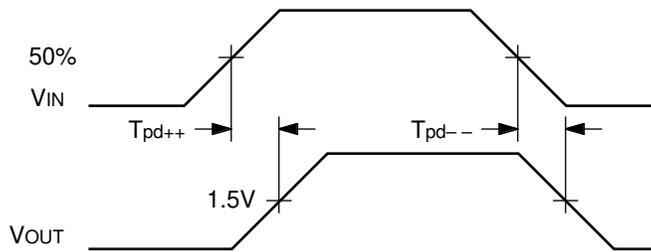
**ECL/TTL WAVEFORMS: RISE AND FALL TIMES**
