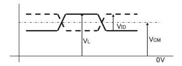
5) V<sub>CM</sub>: LVDS Common mode voltage (V<sub>CM</sub>=1.25V)
