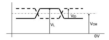
5) V<sub>CM</sub>: LVDS Common mode voltage (V<sub>CM</sub>=1.25V)
