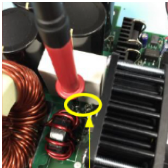
Probing tips: Low side GaN FET V_{GS} and V_{DS}
