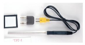
THERM PROBE-LIQUID, TYPE K
