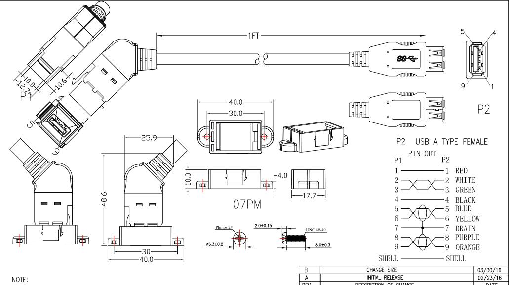
1. CABLE: CABLE:UL20276 USB3.0(1P\*28AWG+D+AL-MYLAR)\*2C+1P\*28AWG+ 2C\*24AWG+AEB(28AWG)+JACKET:PVC, COLOR:BLACK.OD:5.5±0.15mm.
