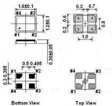
\*\* Recommended - Pin 1 & 3 : CRYSTAL Pin 2 & 4 : GND
