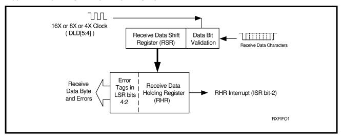
FIGURE 12. RECEIVER OPERATION IN FIFO AND AUTO RTS FLOW CONTROL MODE
