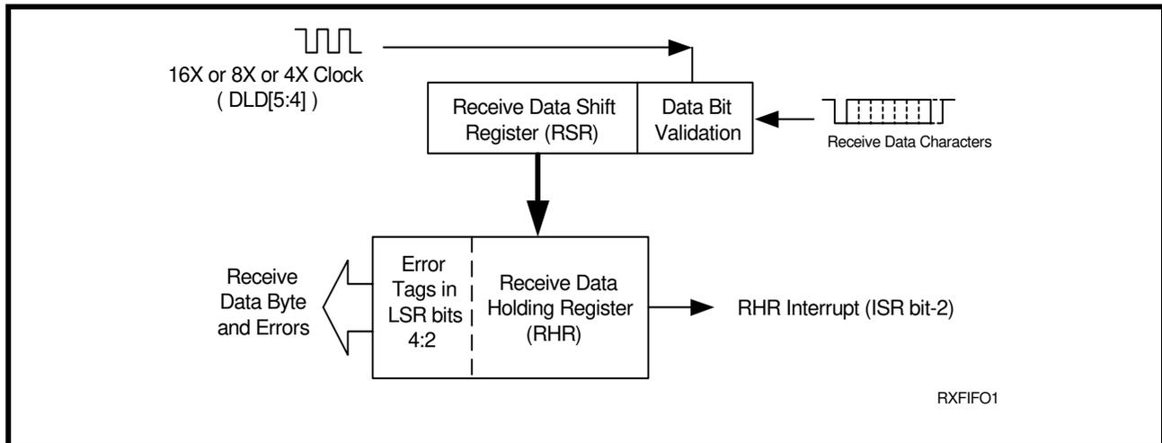
FIGURE 12. RECEIVER OPERATION IN FIFO AND AUTO RTS FLOW CONTROL MODE
