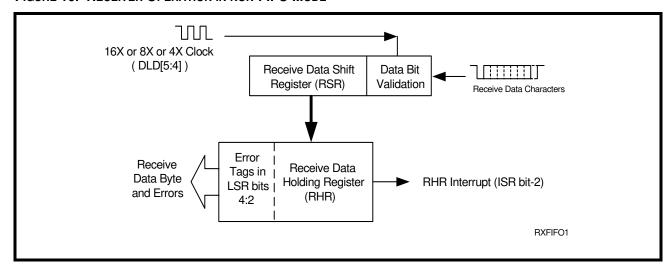
FIGURE 11. RECEIVER OPERATION IN FIFO AND AUTO RTS FLOW CONTROL MODE
