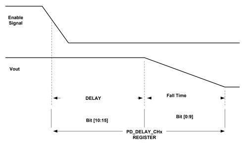
Fig. 25: Channel Soft-Stop Sequence
