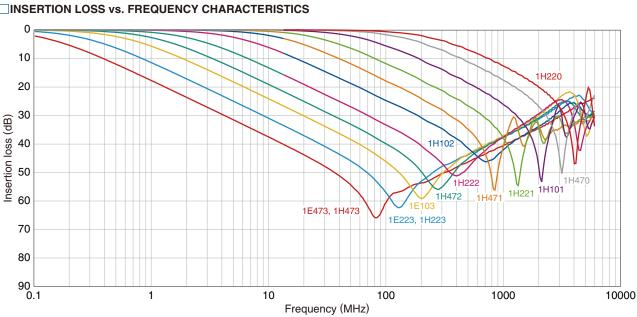
ELECTRICAL CHARACTERISTICS GRAPH **INSERTION LOSS vs. FREQUENCY CHARACTERISTICS**
