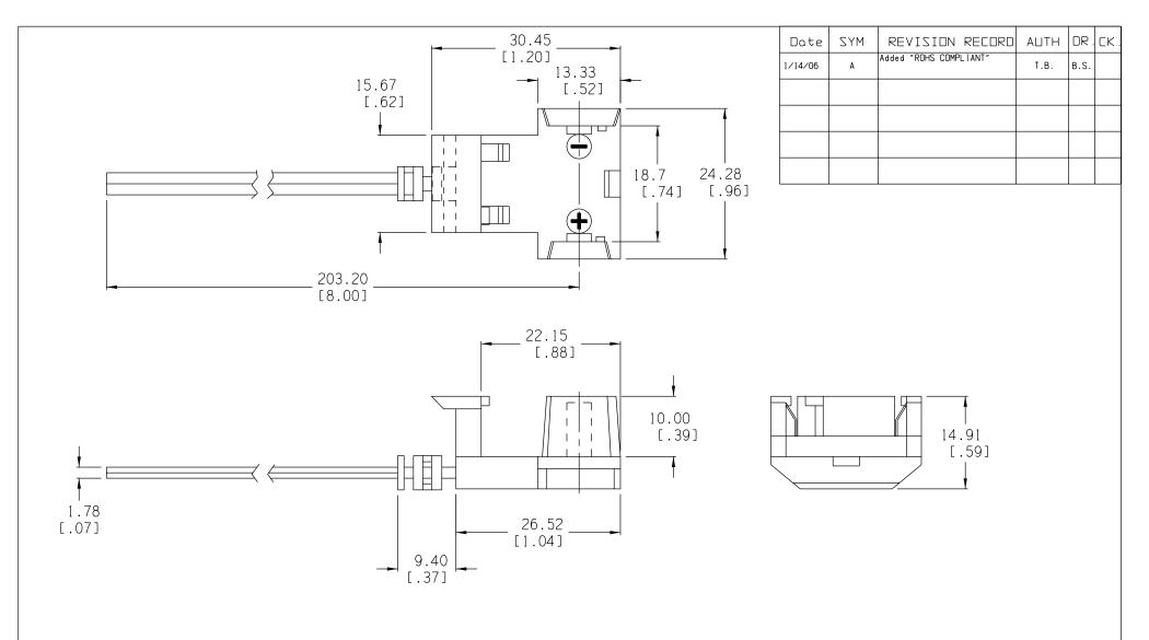
HOUSING: BLACK PLASTIC CORD: UL2468, 300V, 80°C, 22-24AWG PASSES UL FLAME TEST VW-1 FILE NO. E11278 OR EQUAL
